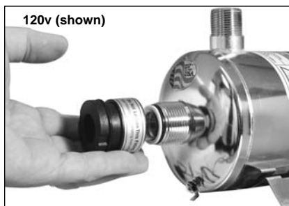
Step 4 - Remove Gland Nuts
