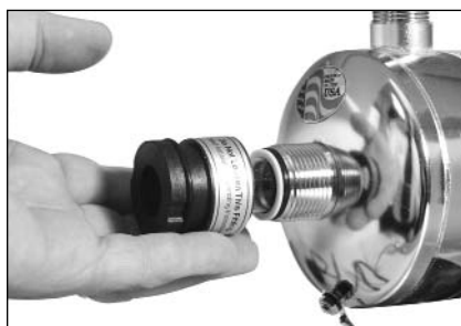
Step 4 - Remove Gland Nuts
